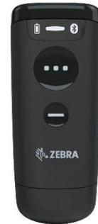
Mit dem CS6080 können 1D und 2D Barcodes eingelesen werden. Durch die geringe Grösse findet er überall Platz. Dadurch kann er in den verschiedensten Bereichen eingesetzt werden. Vor allem im Detailhandel zur Bestandesaufnahme und an der Kasse findet er Einsatz. Der Scanner kann problemlos von der kabellosen zur kabelgebundenen Ausführung oder umgekehrt umgebaut werden. Eine programmierbare Taste macht diesen Scanner noch vielseitiger nutzbar.
